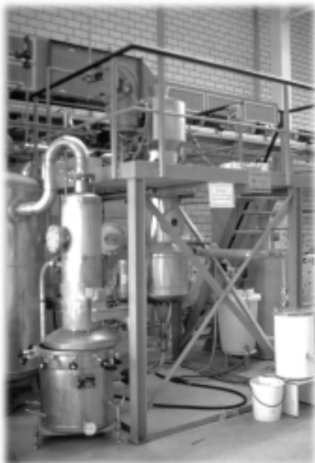
INSTALLATION-TEST POUR LA DÉSAGRÉGATION DU CHANVRE SOUS PRESSION DE VAPEUR (STEAM EXPLOSION)
