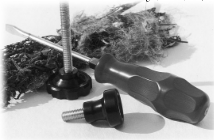
INNOVATION HEMPSTONE - UN MATÉRIAU VARIÉ FAIT À PARTIR DE CHANVRE : INCOMBUSTIBLE, MALLÉABLE ET COMPOSTABLE. LA DENSITÉ ET LA SOLIDITÉ DE ZELFFO 2 VARIENT SELON LE PROCESSUS DE FABRICATION - LES DOMAINES D'APPLICATION DE LA VARIANTE PLANTE ENTIÈRE ET BÛCHETTES VONT DONC DES MATÉRIEAUX D'ISOLATION ET DE CONSTRUCTION JUSQU'ÀUX PIÈCES DE HAUTE QUALITÉ EN PASSANT PAR DES PRODUITS DE REMPLACEMENT DU BOIS.
